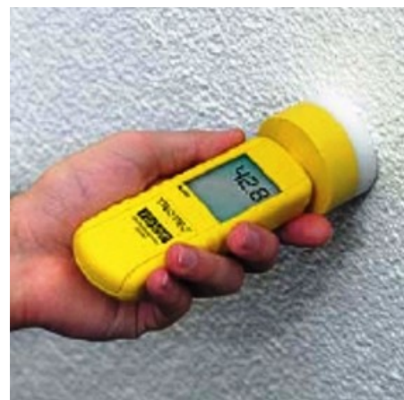
Strumenti di misurazione dell'umidità superficiale (fino a 4 cm) e in profondità (fino a 30 cm circa)
