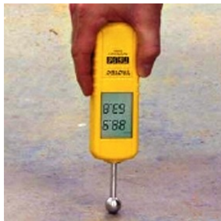
Strumenti di misurazione dell'umidità superficiale (fino a 4 cm) e in profondità (fino a 30 cm circa)
