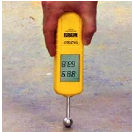
Strumento di misurazione dell'umidità superficiale (fino a 4 cm)
